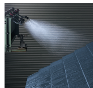
試験条件(※社内試験) ◎勾配4寸 ◎風速(屋根面)30m/s ◎排水量150mm/h
