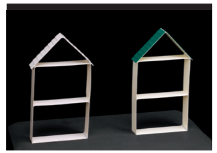
模型による地震振動実験（社内試験） 白い屋根 一般的な陶器瓦の家を想定。 緑の屋根 瓦重量が約40%。エアルーフの家を想定。 ◎他の模型仕様は同一
