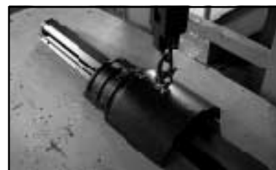
換気7寸素丸瓦引抜き試験
