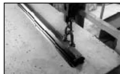
アルミ換気部材引抜き試験
